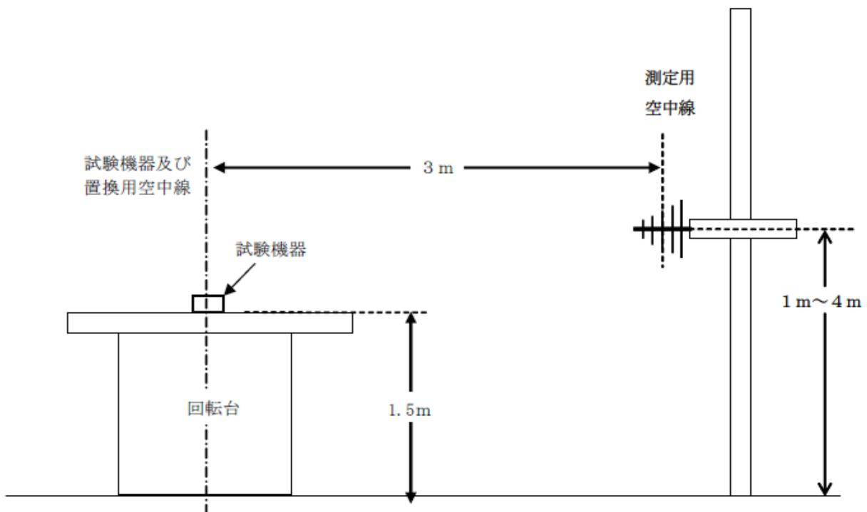
2.5.5.2.1 試験機器は地上高1.5m（底部）の回転台上に乗せ、置換用空中線は地上高1.5mの高さとする。台の材質及び試験機器等の設置条件は、昭和63年郵政省告示第127号「発射する電波が著しく微弱な無線局の電界強度の測定方法を定める件」に準ずる。
