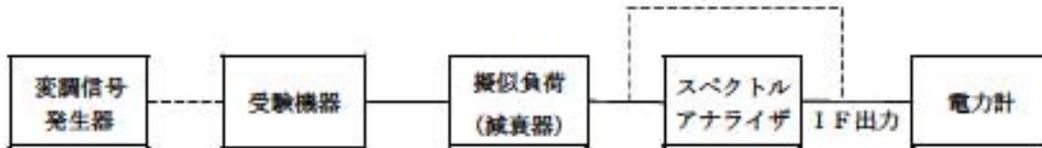
注：減衰器の出力に直接電力計を接続するのは、総電力を測定する場合である。
