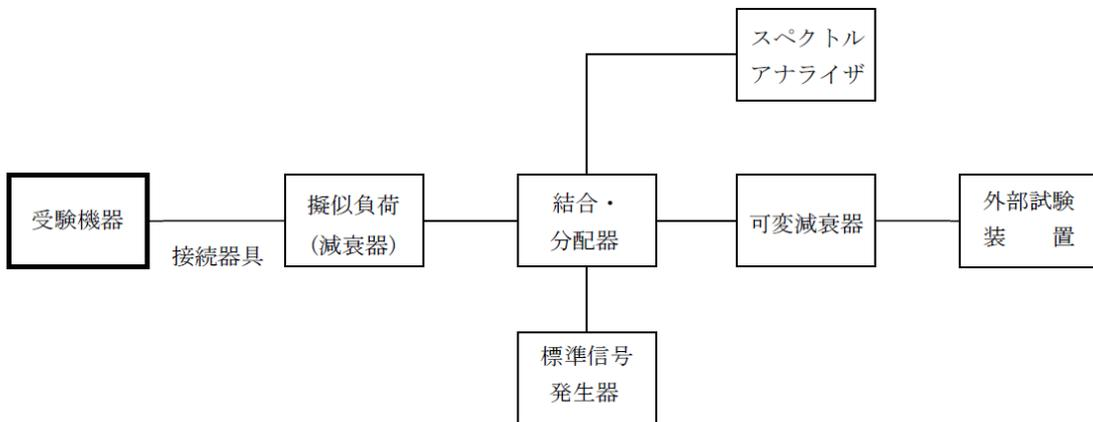
接続器具は、各種導波管変換器等である。
