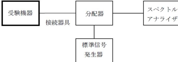
接続器具は、各種導波管変換器等である。
