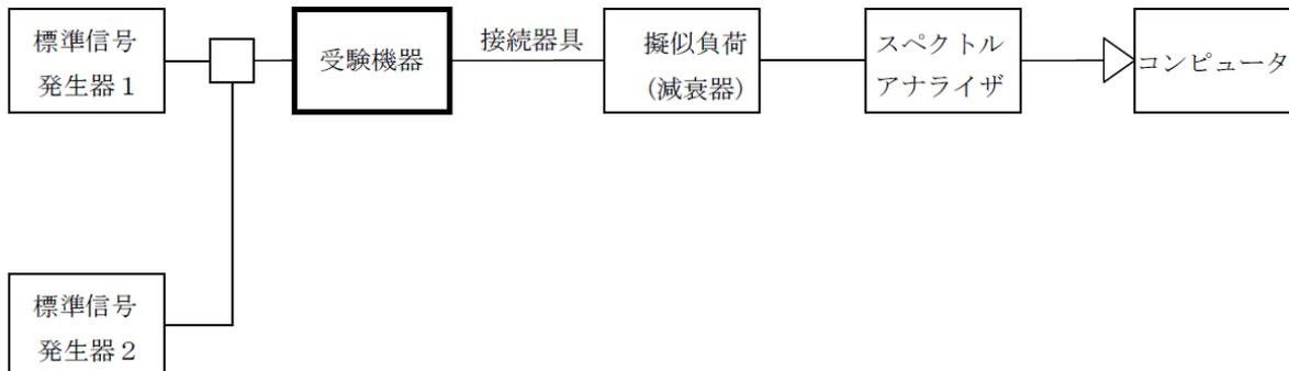
接続器具は、各種導波管変換器等である。
