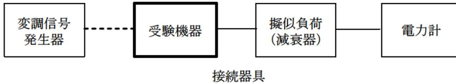
接続器具は、各種導波管変換器等である。
