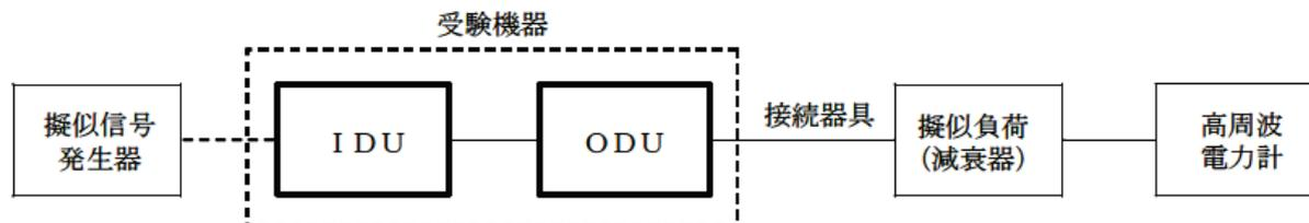
接続器具は、分波器、各種導波管変換器等である。
