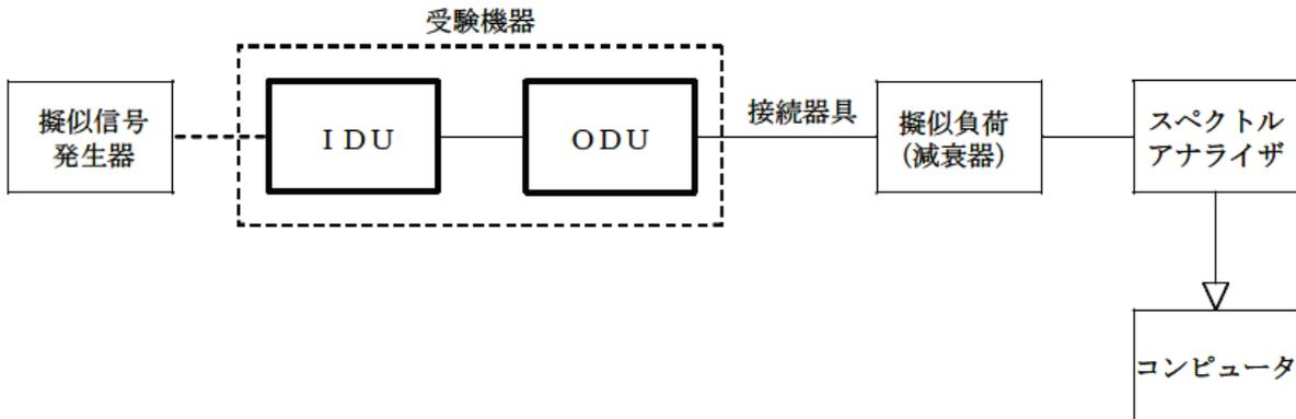
接続器具は、各種同軸導波管変換器等である。
