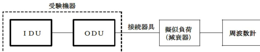
接続器具は、送受信分波器、各種導波管（WG）変換器等である。
