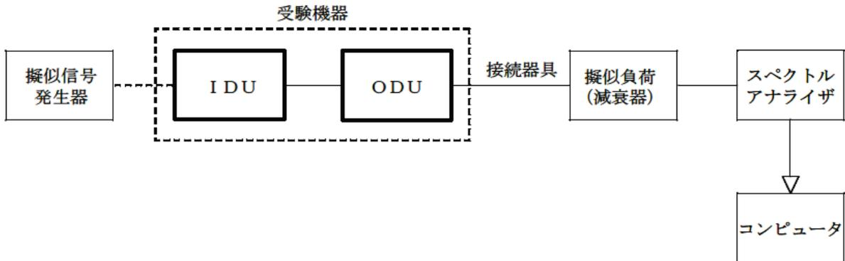
注1 接続器具は、各種同軸導波管変換器等である。
