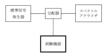
9.1.2 外部試験装置を用いて試験を行う場合
